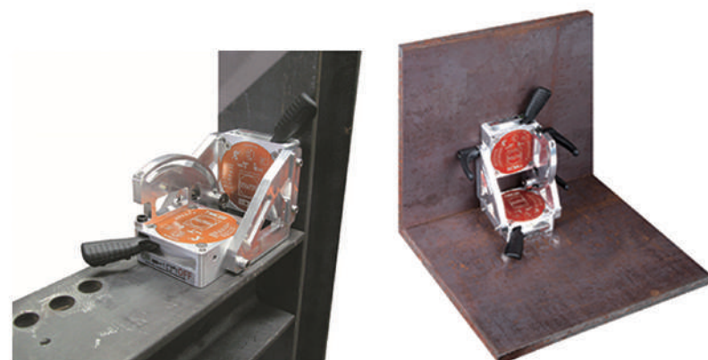
角度をつけた溶接にも
